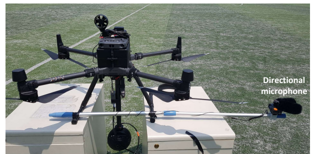
그림 5. 지향성 스테레오 마이크론을 장착한 드론 형상 Fig. 5. Drone with directional stereo microphone
