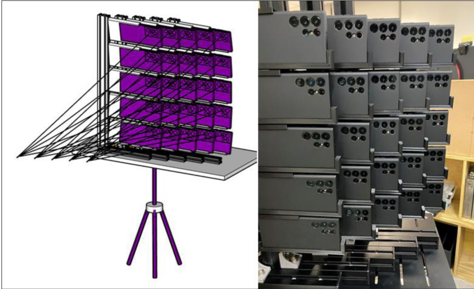
<그림 8> NeRF 학습용 이미지 촬영을 위한 다시점 카메라 시스템
