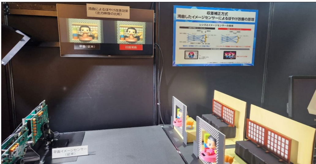
<그림 4-2> 수차 보정 이미징용 곡면 이미지 센서 시연 사진 (출처: NHK STRL Open House 2025)
