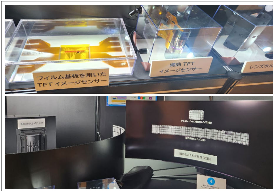
<그림 4-3> 다중렌즈 파노라마 이미징용 곡면 이미지 센서(상) 및 이를 이용한 영상 촬영(하) 시연 사진 (출처: NHK STRL Open House 2025)
