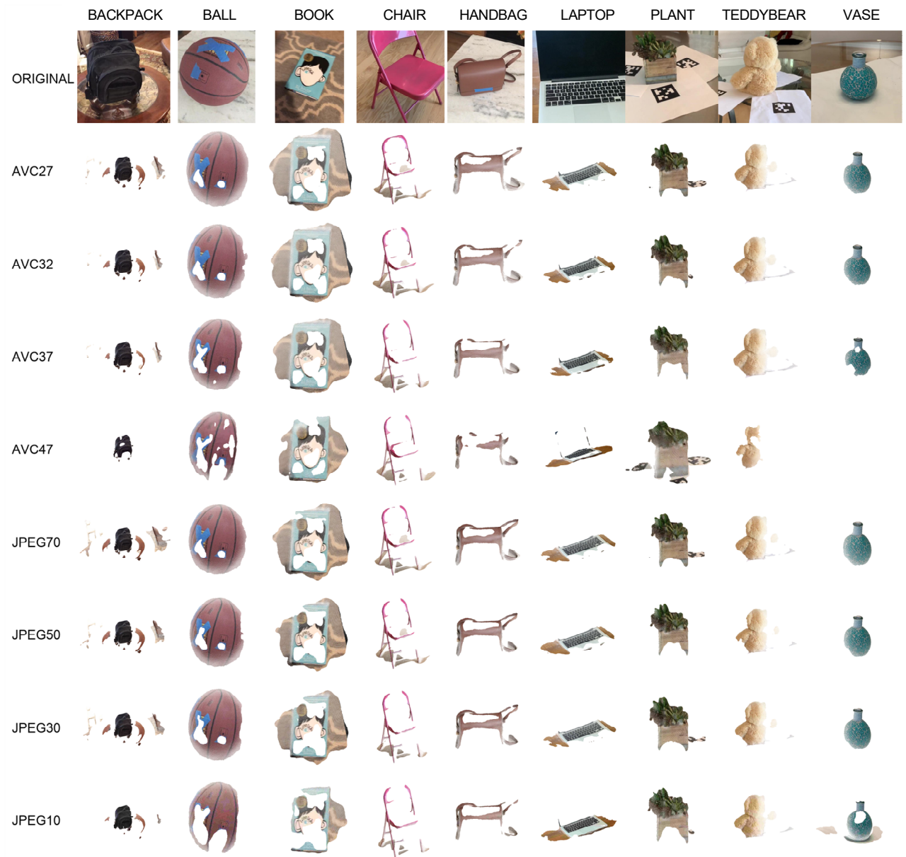
그림 4. 각 카테고리별 압축 강도에 따른 예측된 포인트 맵, 예측이 제대로 이루어지지 않은 장면은 공백 처리
