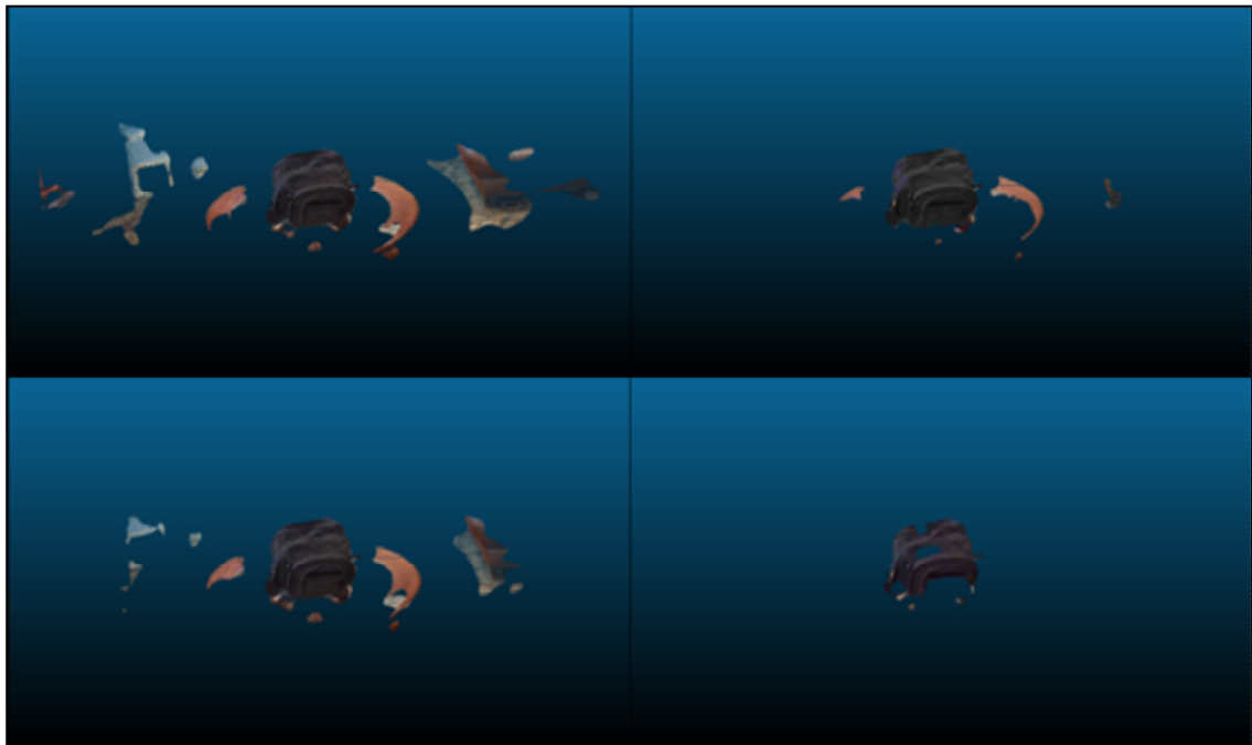
그림 3. CO3Dv2 데이터셋의 backpack 카테고리에 대한 VGGT의 포인트 맵 추론 후 시각화 결과 (위: JPEG Quality 70, 10, 아래: AVC QP 27, 47)
